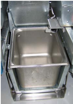
الشكل 3: قم بإدخال مقلاة خزان الزيت الداخلي في وحدة التدوير.
