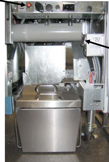
الشكل 7: تظهر وحدة التدوير المجمعة في موضعها.
