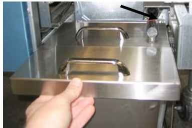
الشكل 4: ضع الغطاء على المقلاة وقم بإدخال أنبوب سحب الزيت في وعاء الامتصاص السالب.
