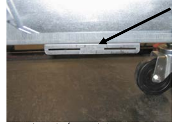
الشكل 1: قم بتركيب كتيفة المحاذة أسفل مشبك صندوق ATO.
